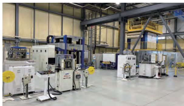
【図表5：大和事業所シェアリングスペース】 解説：1000t から 30t まで、様々な高精度プレスによる加工検証が可能な拠点
