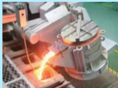
鋳造機械：自動注湯機 ※ 溶かした金属を鋳型に注ぐ機械
