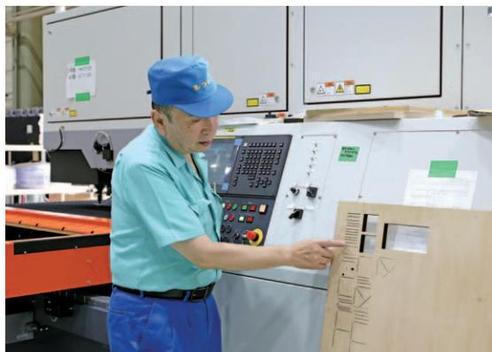
ダイボード加工用ガスレーザ加工機
