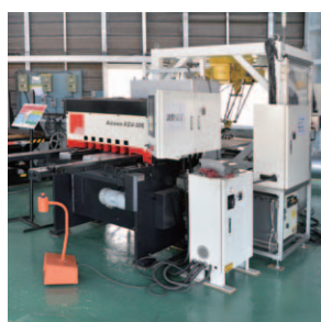
画像処理とロボットを利用した製品の無キズ集積を実現
