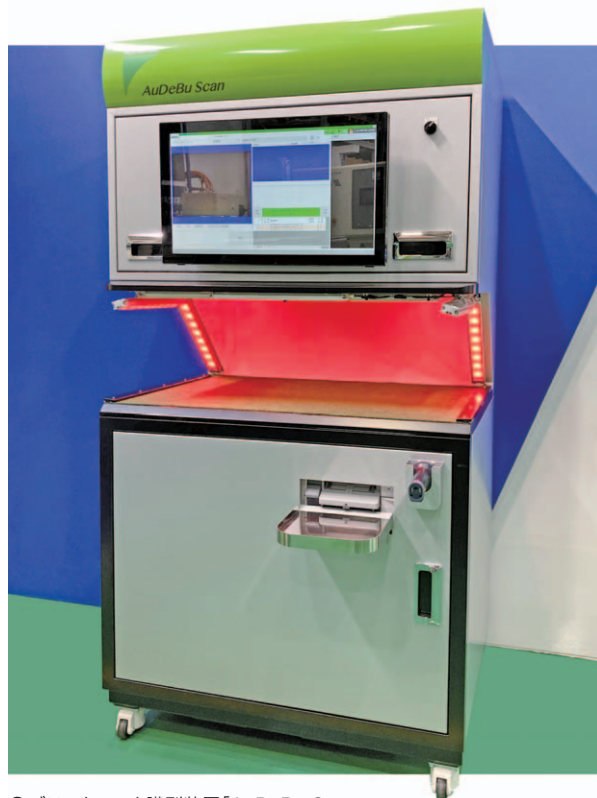
●ブランクワーク識別装置「AuDeBu Scan」
