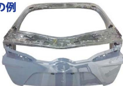
車のバックドアフレーム (CFRP)
