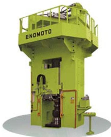
リアーアクスルシャフト(トラックの後部車軸)や、軸端鍛造用に開発したスクリーブレス。プリフォームはタテアプセッター2台を使用し、マテハンロボットで全自動ラインを提供。導入コスト、金型費、メンテナンスコスト大幅低減。割型でないので鍛造品に縦筋がつかない高品質。プレス内でのトランスファー不要で簡単なマテハン。アプセット径は400mm以上まで対応可能。16~20秒でのアウトプット生産。
