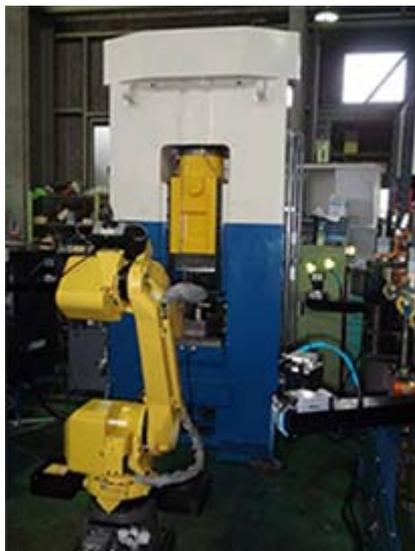
サーボモーター駆動スクリュープレスの小型機廉価版。搭載するサーボモーターは 1 台。制御装置はモーターのコントローラーと共用し低価格を実現した。保守不要、電力消費が少ないなど基本的特徴は ZES 型と同じ。場所を取らず、経済的。
