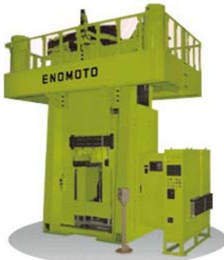
下型は 1 個。ラム上昇後加圧する。上型は 2~3 個で自動的にシフトし、それぞれ異なったパワーでアプセット鍛造する。鍛造エネルギーとラムストロークは自動変換し座屈を防止。Φ100mmまで、長さは最大 3m までの材料に対応可能。
