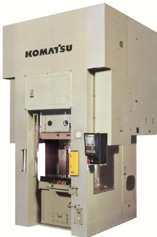
独自のソリッドループフレームとマイプレスモーション(リンクモーション)により、高い生産性と高精度加工を実現します。大きな許容偏心荷重と広いフィードピッチのBKOにより、ワイドなトランスファ加工領域をカバーします。リンクモーションにより発生するスラスト力は、プランジャガイドで吸収し、適切に配置したロング6面ギブと併せて、高い耐許容偏心荷重と高い動的精度を有します。
