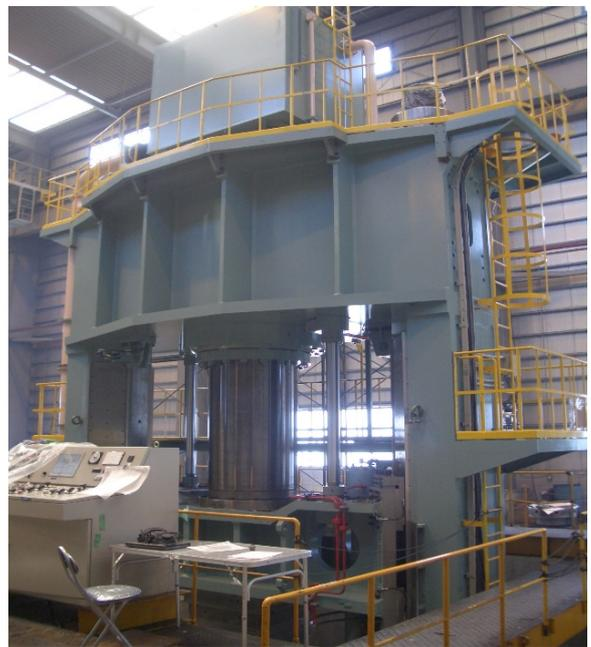
**3600T 鍛造プレス(2柱プッシュダウン型)**
