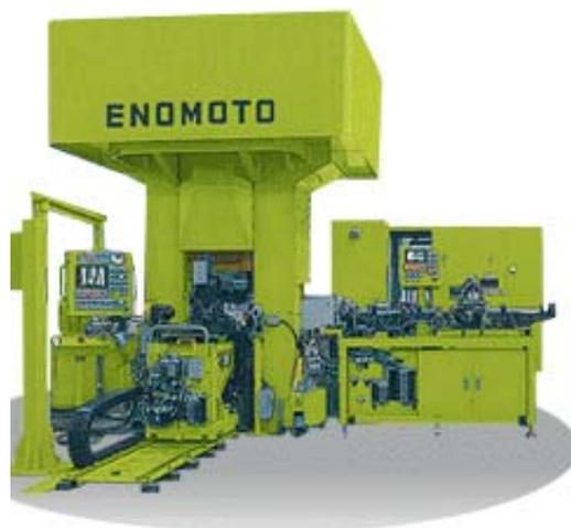
エンジンバルブのビレット材からの押出加工用プレスユニット。押出・傘打の2個の鍛造ステージがあり、全自動で成型する。下死点の無いスクリーブレスの特徴から、足の長さや傘径が成型パワーで自在に変更できる。パーツフィーダー・材料検査装置・高周波加熱炉(プレスフレーム内)・オートハンド・金型潤滑剤塗布装置の一連のラインアップ構成。一つの直径サイズの素材から、多種類のステム径のバルブを鍛造することができ、コスト低減化が可能。
