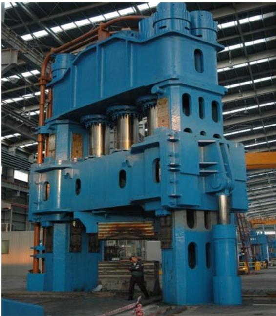
**6500T 鍛造プレス(2柱プッシュダウン型)**
