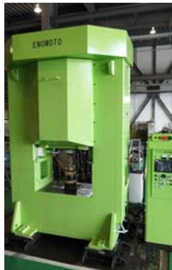
スクリュー軸が2本であるサーボモーター駆動スクリュープレス。偏心荷重に強いワイドベッド機で、3~4のトランスファー加工が可能である。プリフォームや、粗鍛造、仕上げ鍛造、トリミング(ピアス)が同じベッド上で可能である。保守不要、電力消費が少ないなど基本的特徴はZES 型と同じ。
