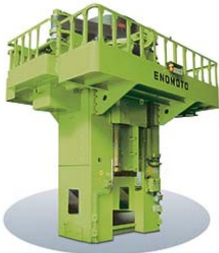
世界に先駆けて、鍛造用スクリュープレスをサーボモーター駆動方式とし、より高精度の精密鍛造加工が可能となった。フライホイールエネルギーは従来のスクリュープレスと同様、一回の加圧ですべて消費されるのでパワフル。
