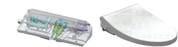
アジア市場を中心に“おしりを洗う文化”的定着を目指し、薄型で高いデザイン性、従来機能をより低成本で提供する「エコウォッシャー」の新商品を開発。従来製品に対して高さ40%ダウンを達成し普通便座並みの薄さを実現。プラットフォーム及びアドオン設計により、外観デザイン違いの商品に対して、ベース部の共用を徹底し開発スピードが30%向上した。また、ビデありの機能違いの商品に対して、部品共用化率97%を達成。さらに、組み立てのねじレス化を進めるなど、生産効率、製造品質の安定化、コスト削減を実現した。
