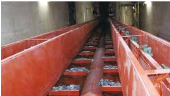
写真1 プレスライン用片持ち式スクレーパーコンベヤ
