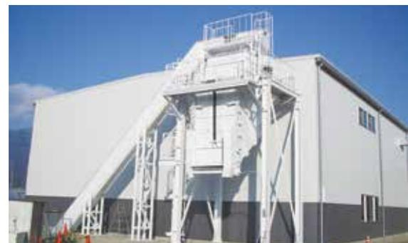
写真4 ホッパー・コンベヤシステム設置例
