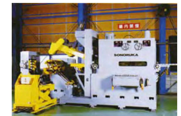
写真4 厚板用コイルライン
