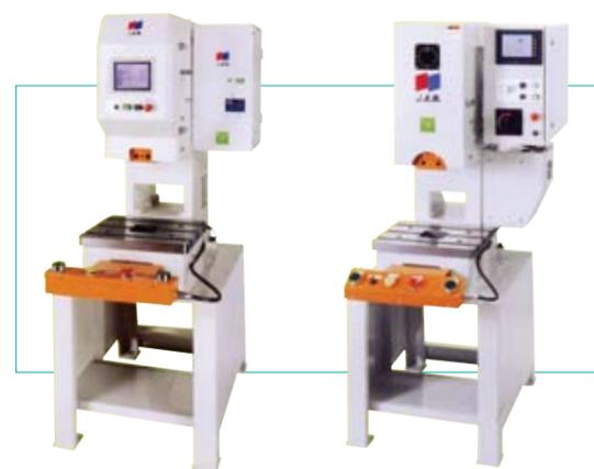
写真1 MFエコマシン認証のスクリーサーボプレス SBP305S
