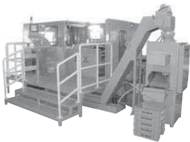
超高速・超高精度 6ステーションパーツフォーマー
