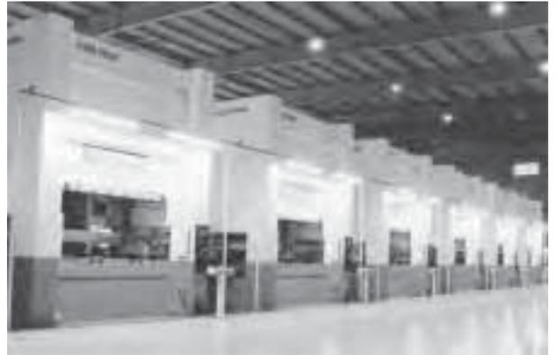
レームの板厚は従来比1.5倍、タイロッド焼締めのない一体桁構造(特許申請中)の採用によって、剛性は約2倍に。約50年の高耐久設計を実現した。同軸減速機構(特許申請中)を搭載し、高トルクで低消費電力、環境にもやさしい。
