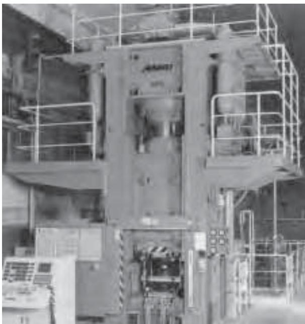
5軸サーボ制御冷間鍛造プレス
