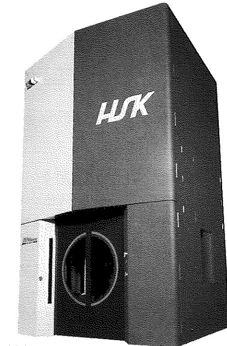
作機械見本市で一般にお目見得した。用途を自動車関連部品に的を絞っている。ゼロ、エキセントリティーロード(偏心荷重)、NC、フォーマーそれぞれの頭文字を取ったネーミングである。今年2月6~8日には、神戸事業所でテクニカル実演会を催した。例えば、一台のプレスから自動車部品のエンジンバルブカムが30個／分でてくる実演に、参加した自動車・部品メーカーが大きな関心を示したという。多品種少量生産という時代背景にマッチしたシステムという評価だ。
