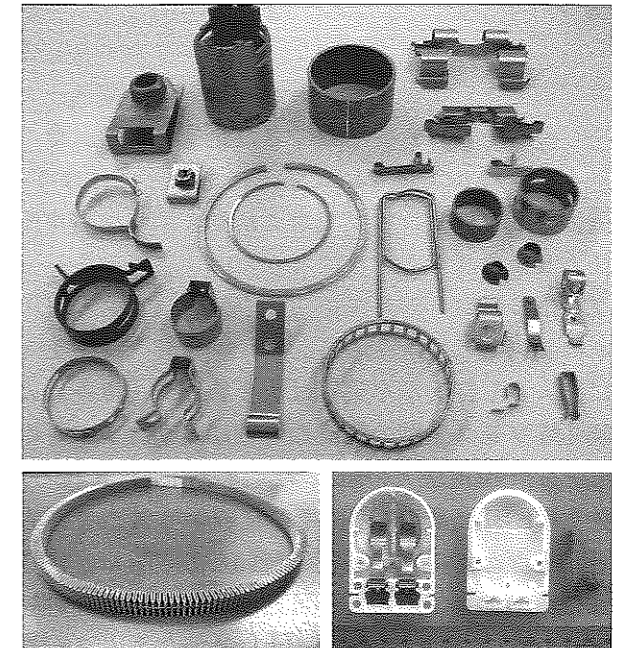
フォーミングマシンによる加工例(写真上) コルゲート曲げ(写真下左)とインサート部品(写真下右)
