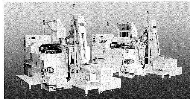
チタン皮膜の密着鍛造成形を行う複合フォーマー
