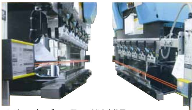
写真2 プレスブレーキ用レーザ式安全装置 AKAS SYSTEM
