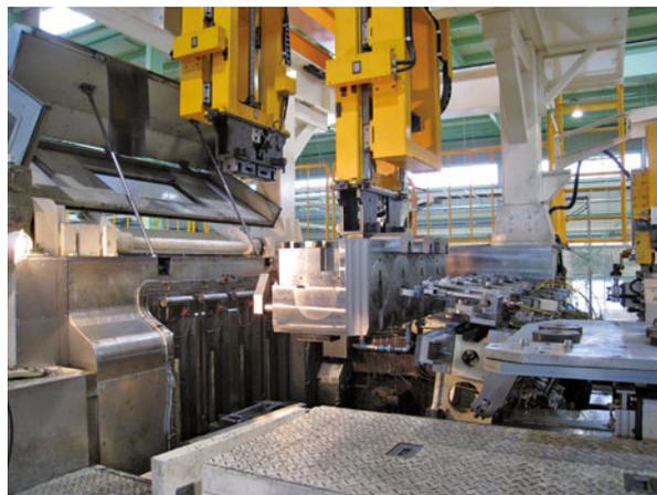
写真4. 交換作業中のATBC(Automatic Tool Block Changer)
