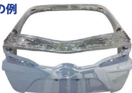
車のバックドアフレーム (CFRP)
