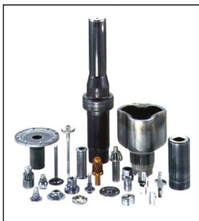
図2. 冷間フォーマーの鍛造事例
