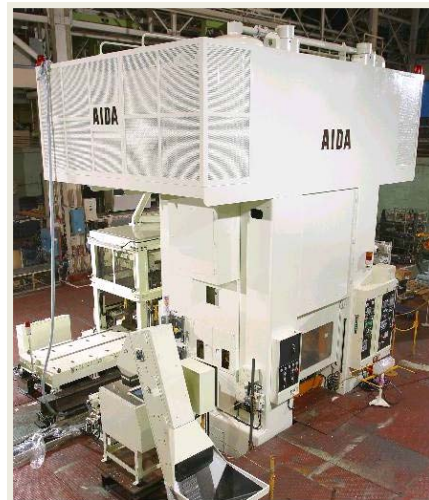
図4. 2ポイントの鍛造用多工程トランスファーリンクプレス
