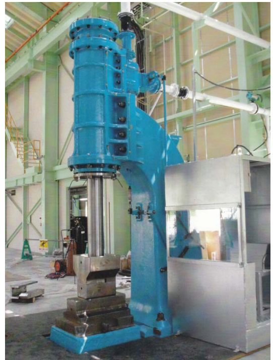
図1. 自由鍛造用(ピストンロッド式シングルフレーム)エアドロップハンマ
