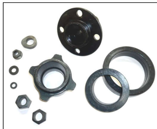
図3. 熱間フォーマーの鍛造事例
