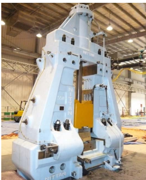
図3. 型鍛造用(ピストンロッド式門型フレーム)エアドロップハンマ
