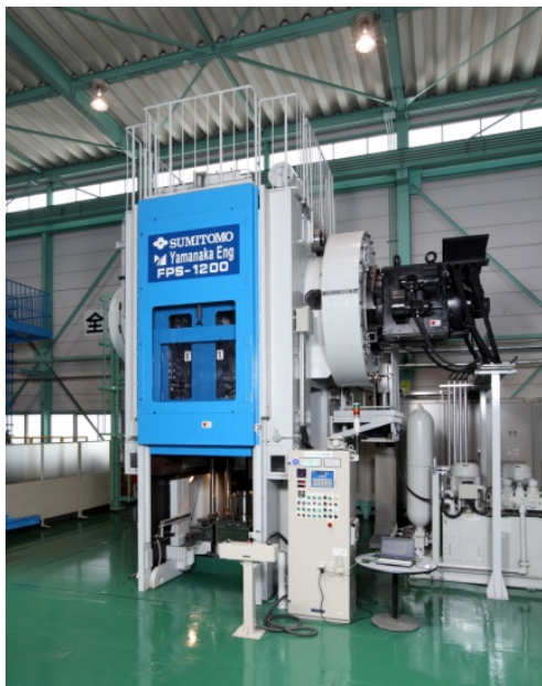
図5. 遊星減速機付き鍛造サーボプレス
