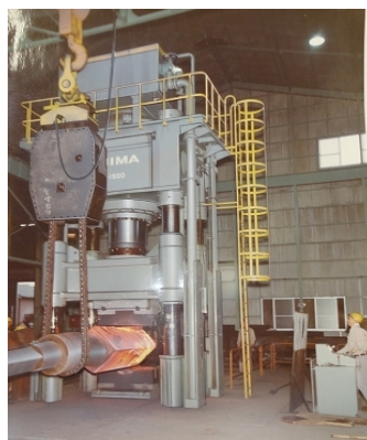
図8. 1500T 4柱下降式油圧鍛造プレス ストローク:1400mm デーライト:2500mm
