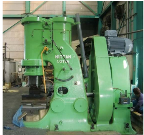
図2.自由鍛造用(ラムピストンロッド式シングルフレーム)エアハンマ
