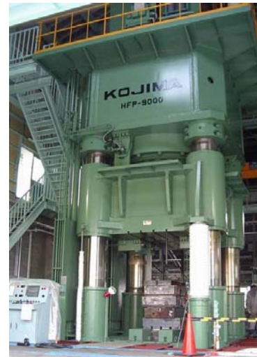
図4. 9000T 熱間鍛造プレス ストローク:1300mm デーライト:2700mm テーブル:1800x2500mm
