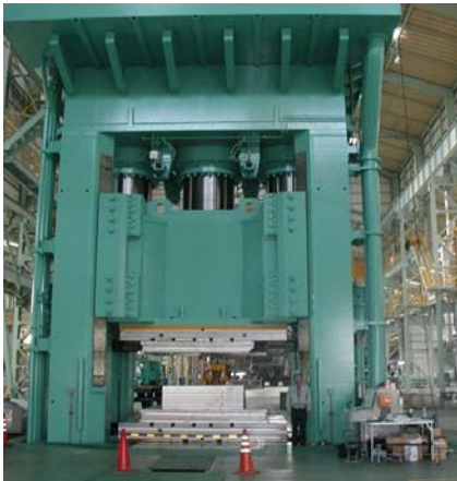
15000T 油圧鍛造プレス 高さ:地上13m、地下8m 幅:8.5m オープンハイト:3300mm ストローク :2500mm テーブルサイズ:4000X3000mm
