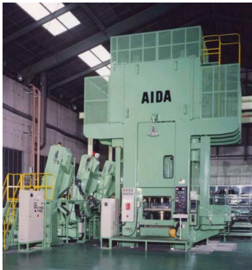
図1. 能力6300kNのリンクプレス
