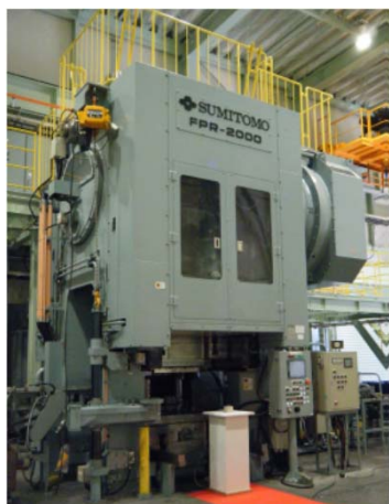
FPRシリーズ(2000ton~4500ton) 2000T 熱間自動鍛造プレス
