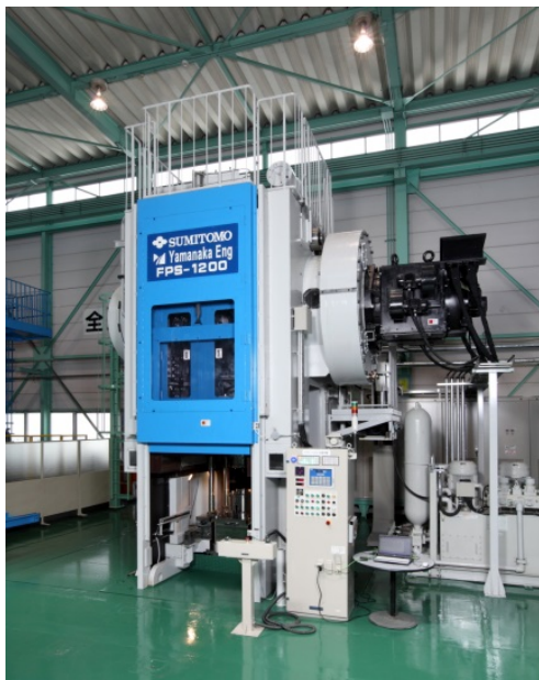
図5. 遊星減速機付き鍛造サーボプレス
