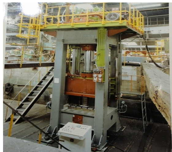
図6. 350T/250T 溶湯鍛造プレス ストローク:1100mm デーライト:1500mm テーブル:800x800mm
