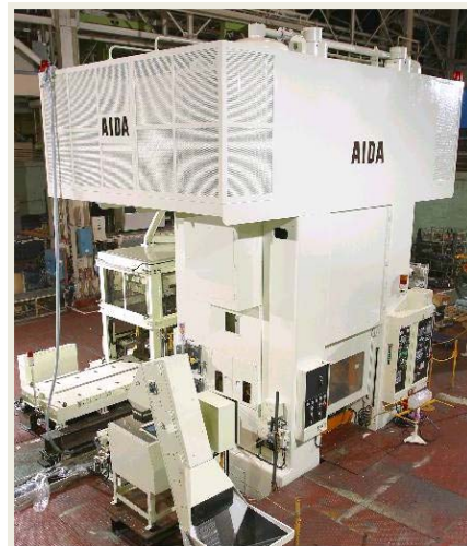
図4. 2ポイントの鍛造用多工程トランスファリンクプレス
