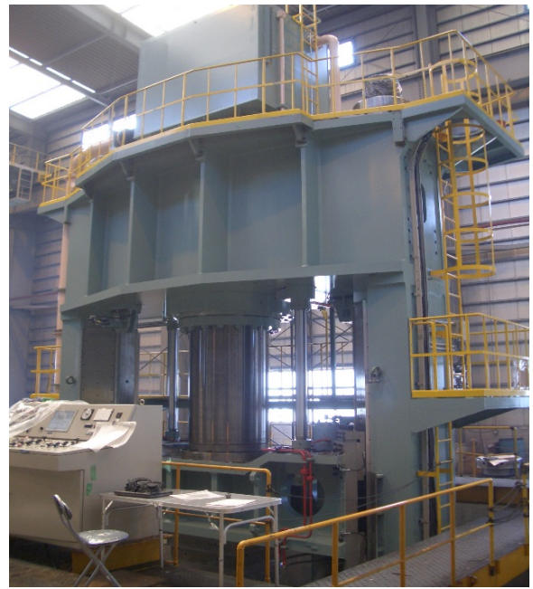
3600T 鍛造プレス(2柱プッシュダウン型) 鋼塊のフリーフォーミングを高速で行う。間口が広く作業性が良い。
