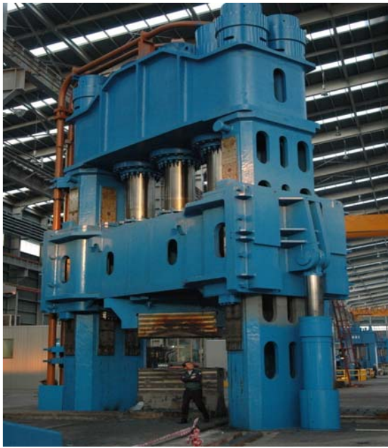
6500T 鍛造プレス(2柱プッシュダウン型) 鋼塊のフリーフォーミングを高速で行う。支柱のガイドが強固で偏芯加重に強い。
