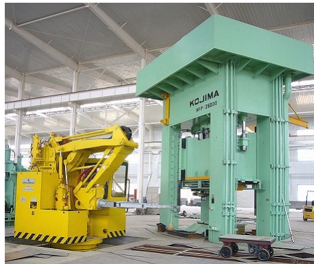
2500T 鍛造プレス テーブル:3250x1500mm ストローク:1700mm デーライト:2500mm
