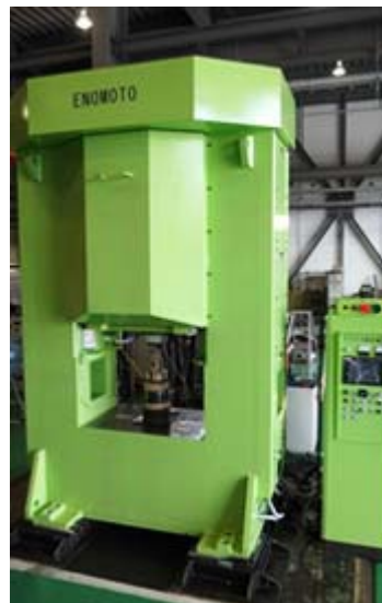
TES型サーボ駆動ツウインスクリュープレス 315~2000 TON
