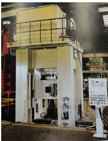
図5. 500T 冷間鍛造プレス ストローク:600mm デーライト:950mm テーブル:1200x1000mm
