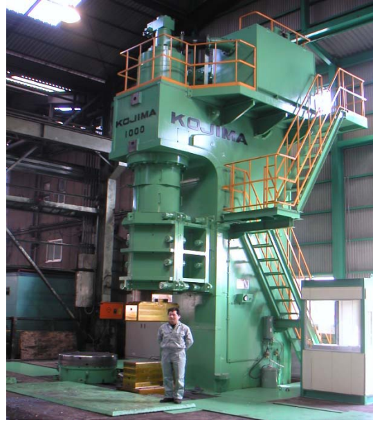
1000T 鍛造プレス(片持型) 鋼塊のフリーフォーミングを高速で行う。三方が開いているので作業性が良い。
