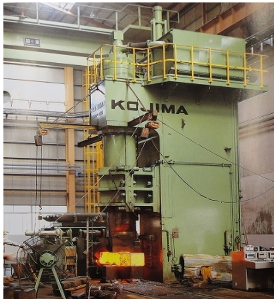
750T 鍛造プレス(片持型) 鋼塊のフリーフォーミングを高速で行う。三方が開いているので作業性が良い。
