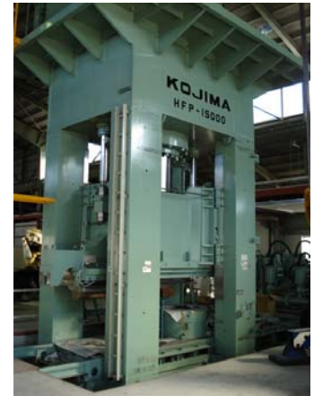
1500T 鍛造プレス テーブル:3000x1250mm ストローク:1300mm デーライト:2000mm
