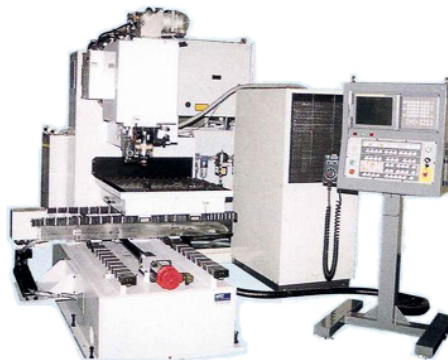
図 26. テーブル移動型加工機の例
