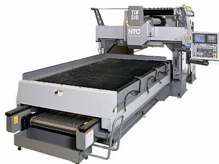
図 29. ハイブリッド型加工機 (光移動+テーブル移動式)
