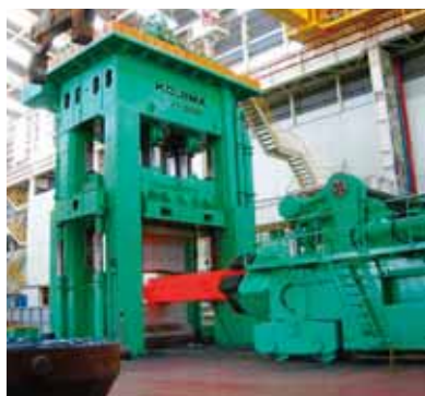
5000T / 10000T鍛造プレス全体 (自由鍛造中)
