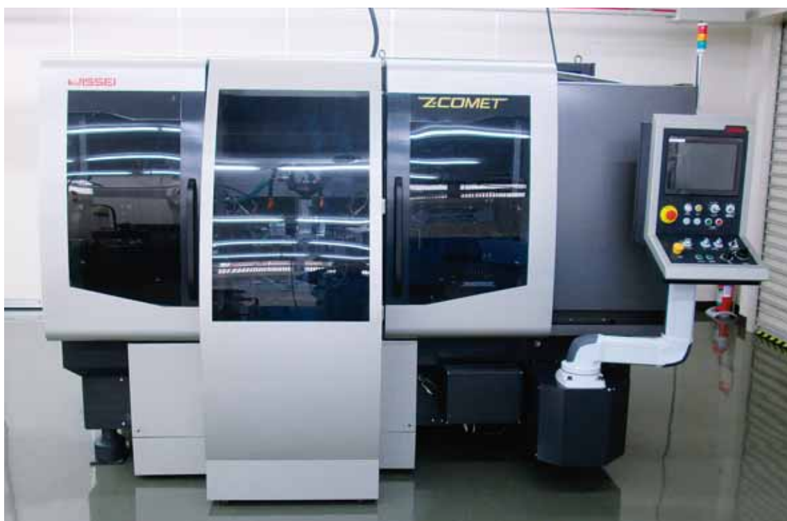
図1. 歯車仕上げ転造機「Z-Comet」
