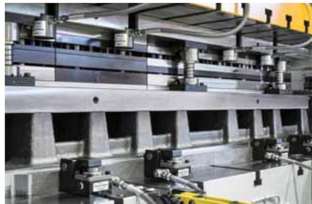
プレス加工の少量多品種生産が効率的に行える「パスカルダイクランピングシステム」
