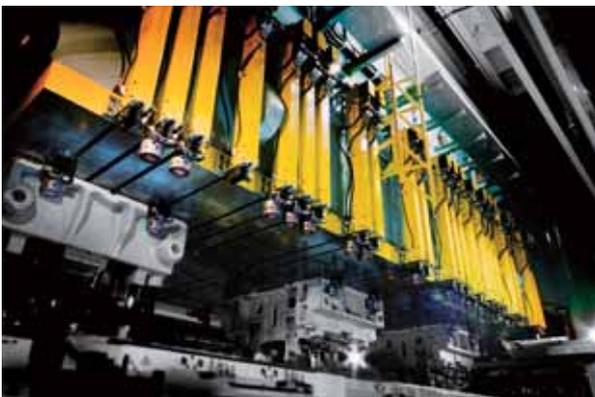
金型まで自動的に移動する革新的な「パスカルトラベリングクランプ」
