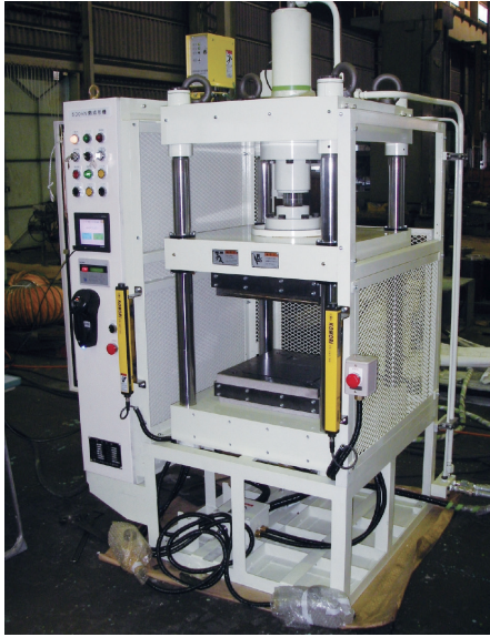
写真4 500kN 4柱式熱成形機 CFRPの加熱成形などに使用
