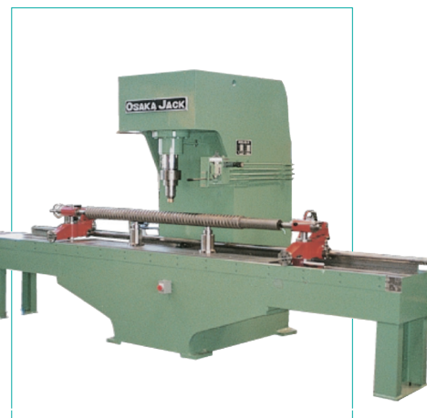
写真3 500kN C形歪取りプレス 熱処理後の丸棒の矯正用
