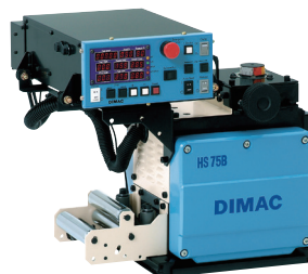
写真2 高速プレス対応NCロールフィーダ HS75B (～SPM1600)
