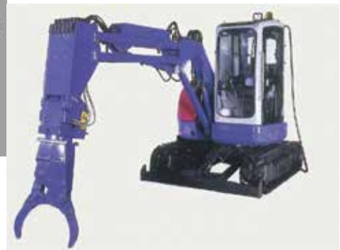
写真2 自社設計の自走式重量物ハンドリングロボット バイラテラルマスター
