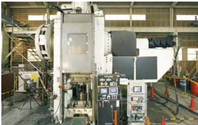
図5 試作用8MN鍛造サーボプレス
