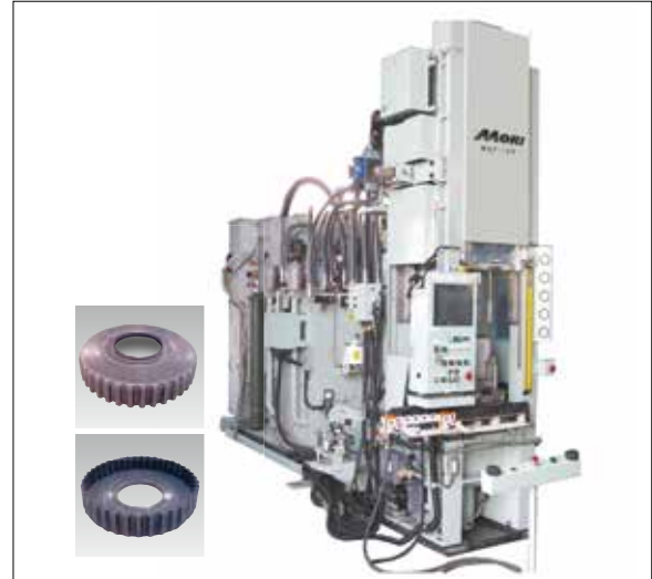
2000kN 5軸複動油圧プレスと成形したクラッチハブ
