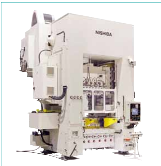
写真1 250トントランスファプレス
