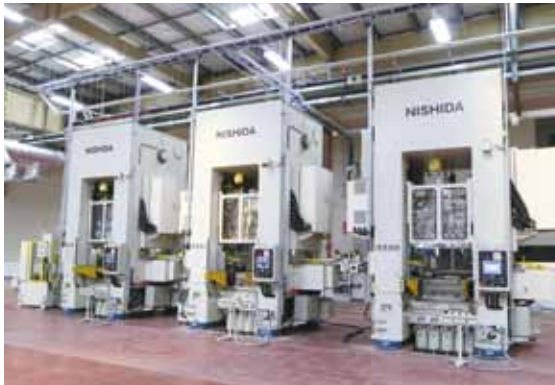
写真3 300トントランスファプレス3連ライン
