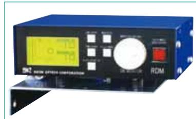
写真5 歪み検出型プレスミス検出装置
