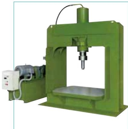
写真1 油圧破砕機
