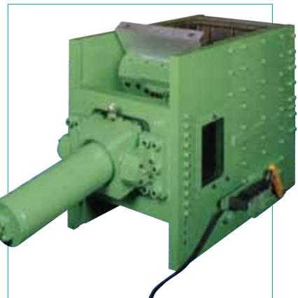
写真3 連続湯道破砕機(クラッシャー)ランナーブレイカー
