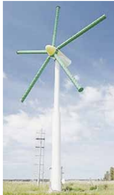
図表3 MECARO社のスパイラルマグナス風車
