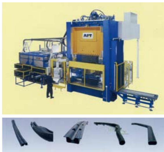
写真1~2 熱間高速鍛造プレスと温間成形加工サンプル
