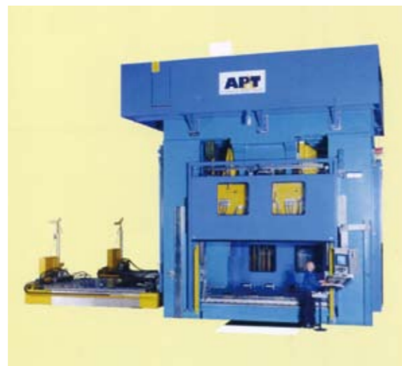
写真3 ショートストローク式ハイドロフォーミングプレス(HF100MN)
