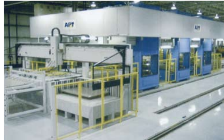
写真4 フルターンキー自動プレスライン(プレス・自動機・金型)
