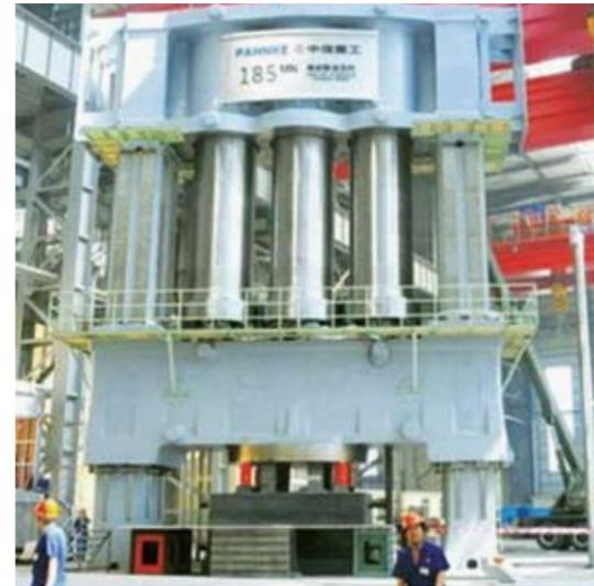
写真1：世界最大の鍛造用油圧プレス 18,500トン
