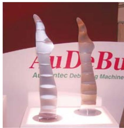
写真2 AuDeBuで面取りしたストックング検査機
