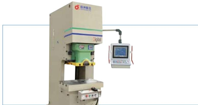
写真5: 600kN サーボプレス (揚州鍛圧)
