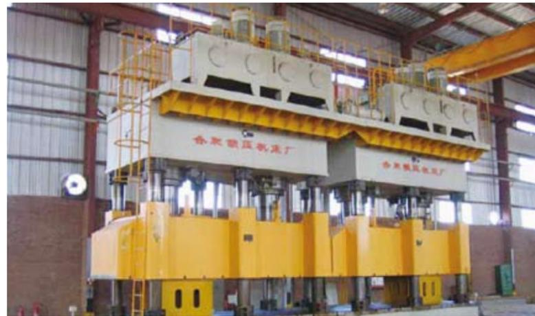
写真6: 4000トン油圧プレスシステム (合肥鍛圧)
