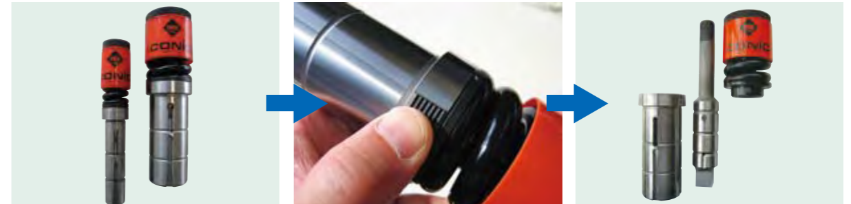
写真2 完全工具レスで秒速メンテを可能にした「PROTECH-II」
