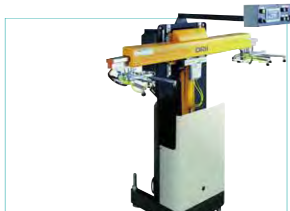
写真2 高い納入実績を有する2軸サーボ「RYNロボット」
