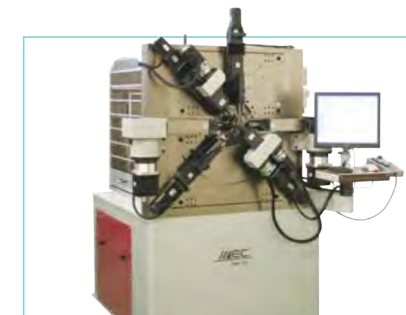
写真4 16軸のサーボモーターにより多様な動きを実現する精密ばね成形機「VM-26」
