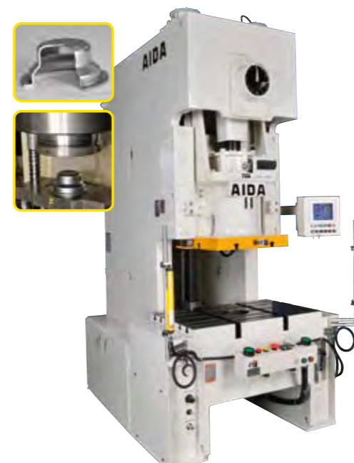
写真1 Simple / Ecology 機能を組み込んだ「サーボ化改造システム」
