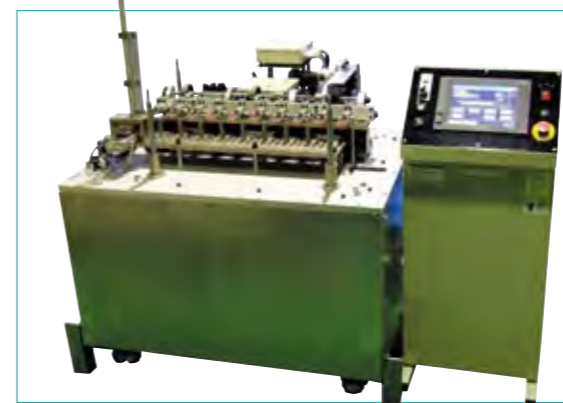
写真3 高速2次元トランスファユニット「RX009」
