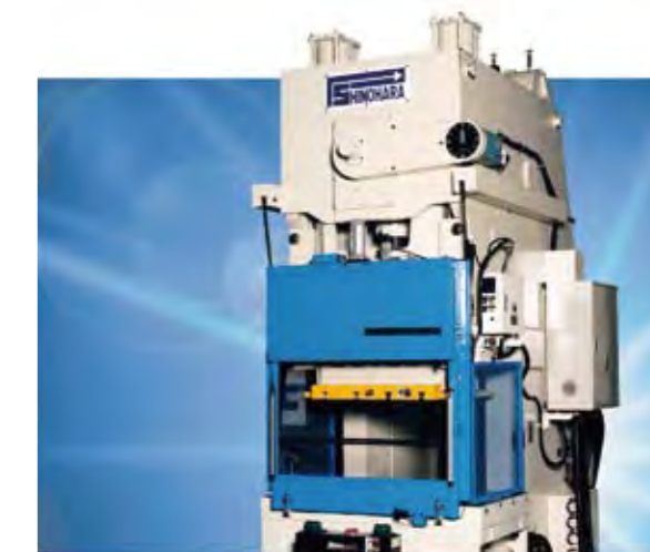
写真3 Safety / Easy 機能を持つ「シャッターガード」
