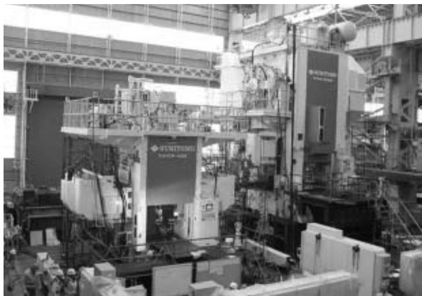
6500T熱間鍛造プレスラインの組立風景
